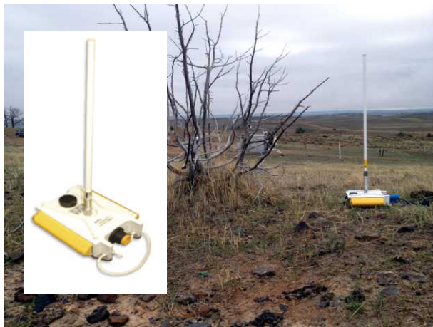
▲ Рис. 2. На внешней части корпуса WRU расположены: антенна повышенной прочности диапазона 2,4 ГГц; стандартный разъем геофона; антенна GPS; статусные индикаторы и две аккумуляторные батареи (по одной с каждой стороны)
