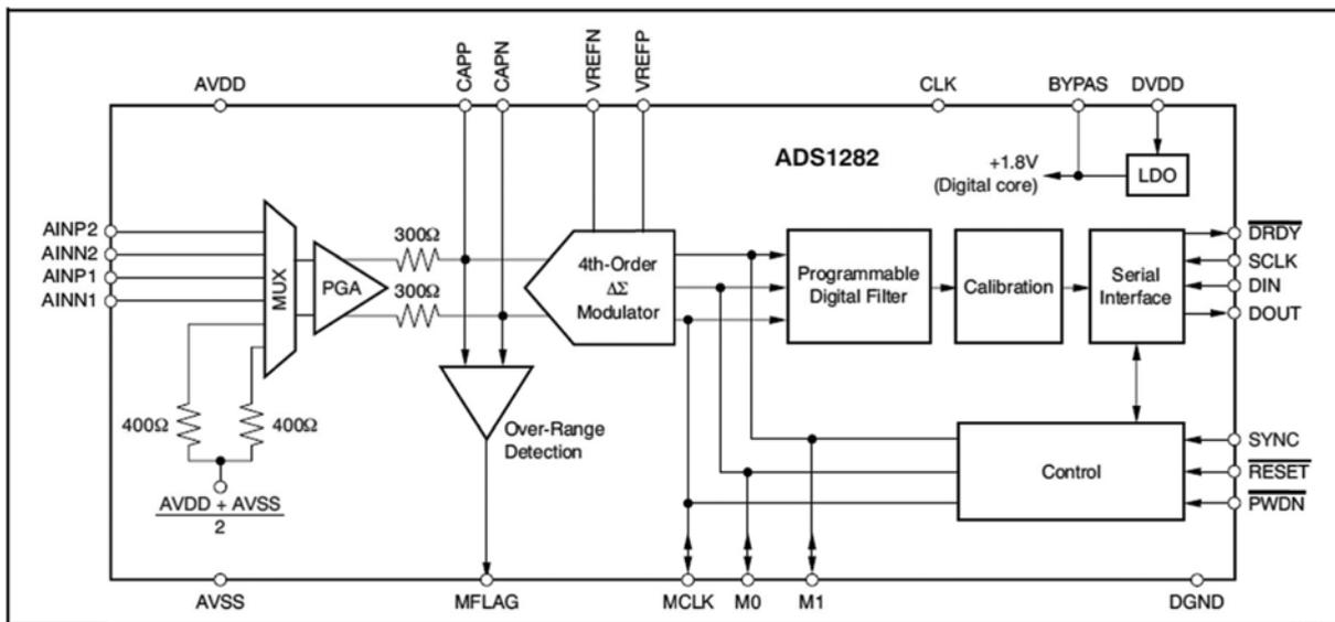
**Figure 30. ADS1282 Block Diagram**
